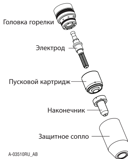
Компоненты горелки
