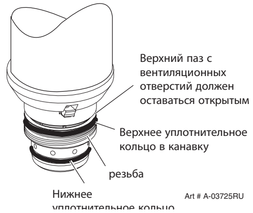
Уплотнительное кольцо головки горелки
