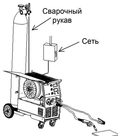
**Не забудьте заземлить аппарат для предотвращения возникновения статического электричества и утечки токов.**
