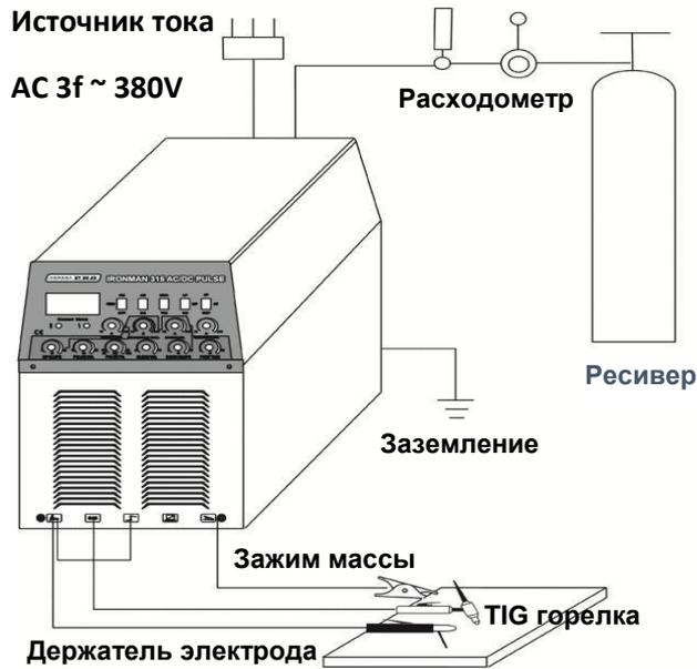
3. Используйте провод заземления, площадь сечения которого не менее 6 мм<sup>2</sup>, подсоедините его к контакту заземления на задней панели аппарата.
