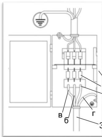
**Схема подключения сети питания AC 3f ~ 380V**
