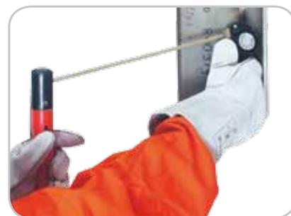
Беспроводной пульт дистанционного управления R11-T можно использовать просто путем касания электрода
