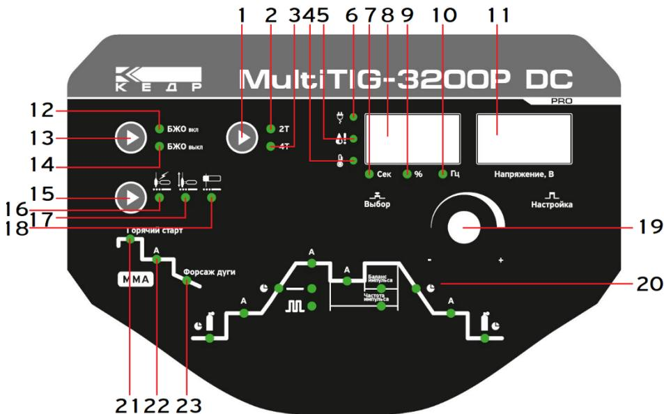
1. Кнопка выбора 2Т/4Т режима работы триггера горелки.
