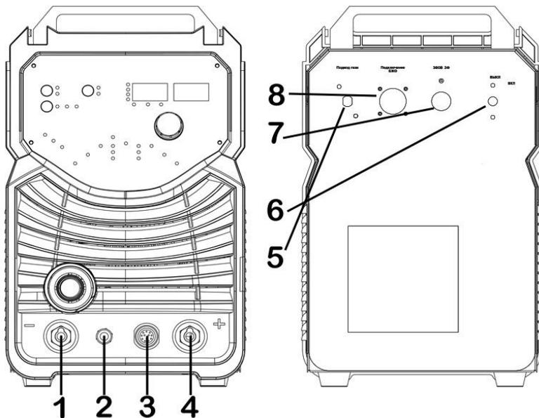
1. Отрицательный силовой разъем: подключение аргонодуговой горелки.
