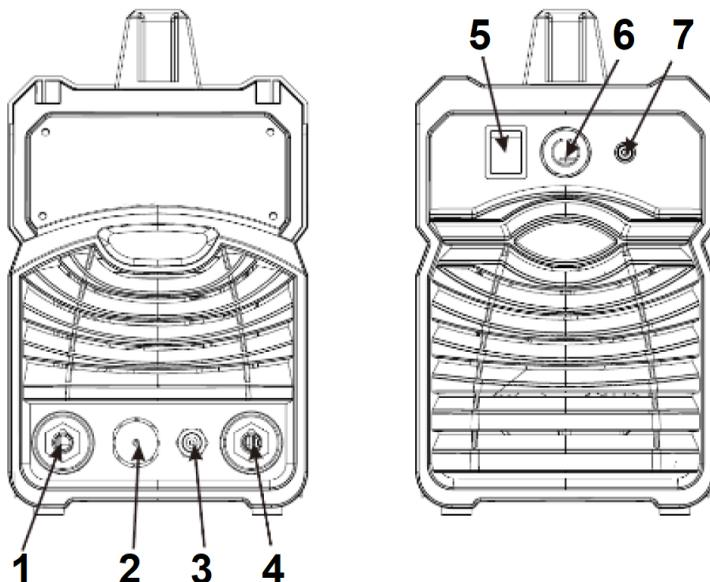
1. Отрицательный силовой разъем: подключение аргонодуговой горелки.
