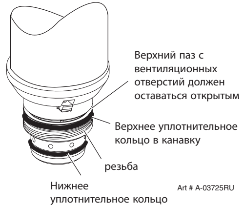
Уплотнительное кольцо головки горелки
