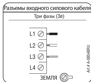
Подключение трехфазного питания
