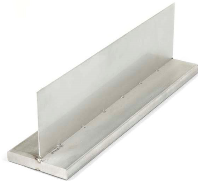
Рис. 1. Функция MicroTask также хорошо подходит и для соединения прихваточным швом тонких и толстых заготовок благодаря низкому тепловложению и относительно высокой плотности энергии.
