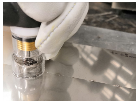
Рис. 3. Техника сварки, основанная на использовании прозрачного стеклянного газового сопла Puxex. Листы, соединяемые прихваточным швом, изготовлены из кислотоустойчивой стали (316L) толщиной 0,5 мм.
