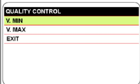
Выбрать минимальное напряжение (MIN. V) или максимальное напряжение (MAX. V.), затем подтвердить установку промежуточного значения.
