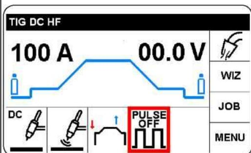
Выберите и подтвердите секцию N в отношении импульса для получения доступа к режимам PULSE ON (ИМПУЛЬС ВКЛ) (раздел 8.1) или PULSE ON-XP (ИМПУЛЬС ВКЛ-XP) (раздел 8.2).
