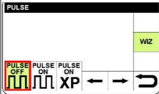
Если выбрано **PULSE OFF** (ИМПУЛЬС ВЫКЛ), на дисплее отображается главный экран. Если выбрано **PULSE ON** (ИМПУЛЬС ВКЛ), см. пункт 8.1, а если выбрано **PULSE ON -XP** (ИМПУЛЬС ВКЛ-XP), см. пункт 8.2.
