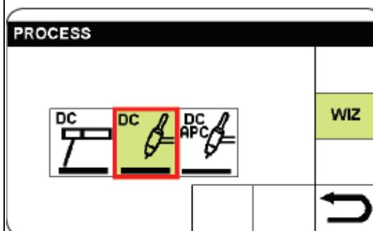
Выберите и подтвердите сварочный процесс. Следующий выбор отобразится автоматически.
