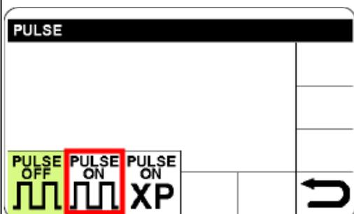
Выберите и подтвердите PULSE ON (ИМПУЛЬС ВКЛ) для получения доступа к настройке параметров импульса.
