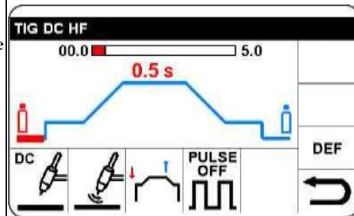
Подтвердить и установить выбранный параметр. Затем нажать для подтверждения настройки и автоматически перейти к следующему параметру или повернуть ручку В для выбора необходимого параметра.
