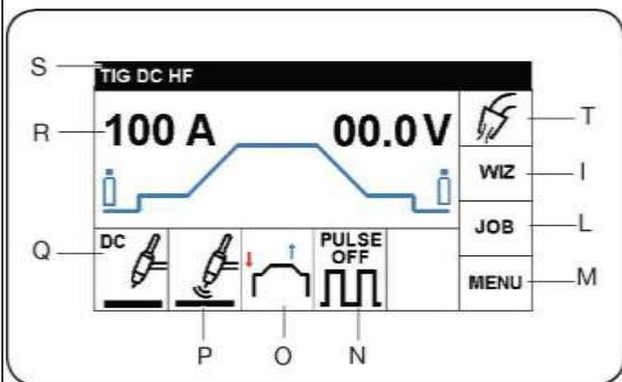
Как указано на рисунке, дисплей разделен на секции. В каждой секции можно выполнить соответствующие настройки.
